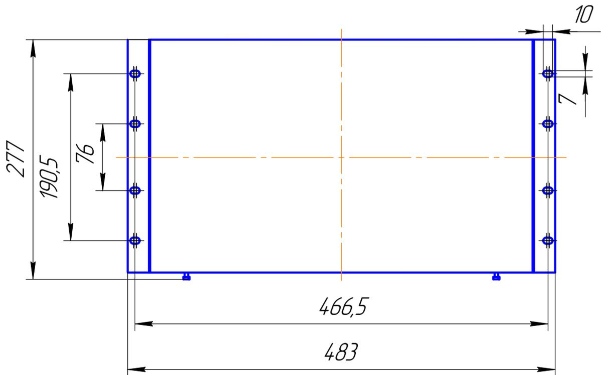
Рисунок 2.1 – Разметка щита для установки газоанализаторов
